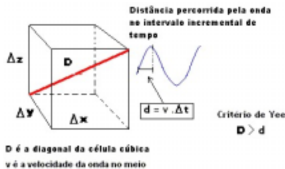
Figura 4.2 Critério de estabilidade de Yee onde D = \sqrt{(\Delta x^2 + \Delta y^2 + \Delta z^2)}
