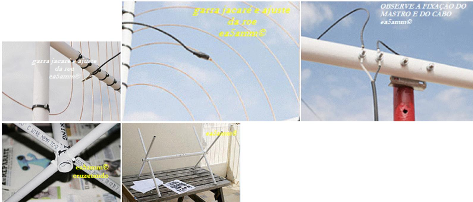
**O AJUSTE DA ESTACIONÁRIA É FEITO VARIANDO SIMULTANEAMENTE POR MEIO DE GARRA JACARÉ A LIGAÇÃO DO CABO A PARTIR DO INÍCIO DAS ESPIRAS ( COMEÇO DO ENROLAMENTO)ATÉ ENCONTRAR O MELHOR PONTO, QUANDO ENTÃO SERÁ FEITA A FIXAÇÃO POR SOLDA. O AJUSTE DA ROE DEVE SER FEITO NA FREQUENCIA PARA QUAL A ANTENA FOI CALCULADA .É UM AJUSTE CRÍTICO E DEVE SER FEITO MILÍMETRO A MILÍMETROS E COM MUITA PACIÊNCIA. O PONTO DA MELHOR ROE PODERÁ VARIAR BASTANTE DE UMA ESPIRAL PARA OUTRA. PACIÊNCIA!**
