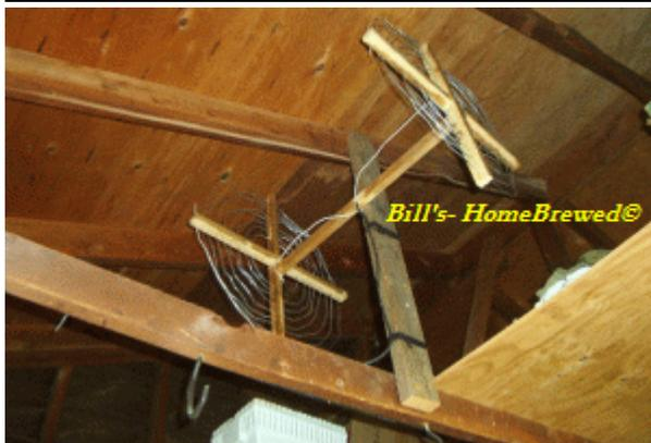
A ANTENA PARA AJUSTE DEVE FICAR NO MÍNIMO A 2 METROS E MEIO DO SOLO.
