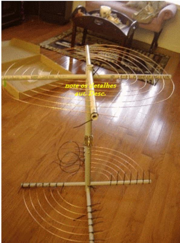
O COAXIAL DE DESCIDA DEVE SER COLOCADO NO CENTRO DO BOOM E LIGADO ÀS ESPIRAS POR MEIO DE FIOS DE COBRE RÍGIDO ENCAPADO MESMO DIÂMETRO DO USADO NAS ESPIRAIS.
